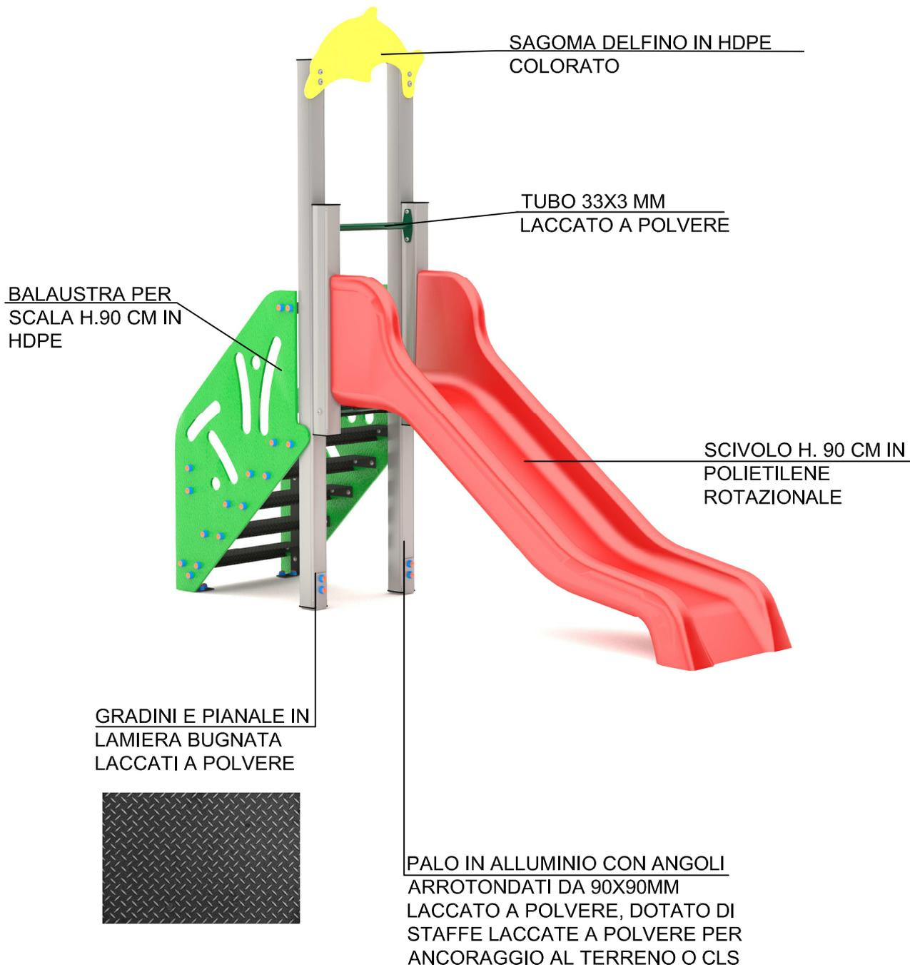
TUTTI GLI ELEMENTI DI FISSAGGIO, VITI, DADI, RONDELLE ECC. SONO IN ACCIAIO ZINCATO E PROTETTI DA GHIERE E TAPPI IN POLIETILENE.
